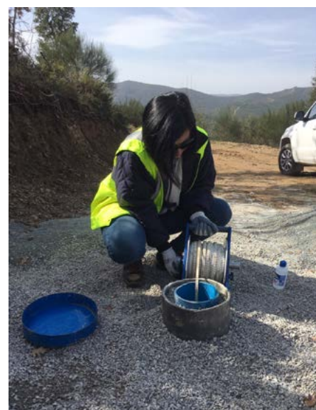
Monitorização do nível de água subterrânea num furo de água
